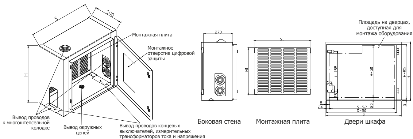
Рисунок 3а - Шкаф вспомогательных цепей в распределительном устройстве RXD
